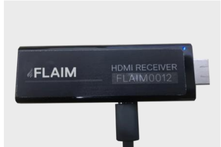
Figur 4: Sørg for, at HDMI-receiveren er tændt (blåt lys i øverste højre hjørne)
